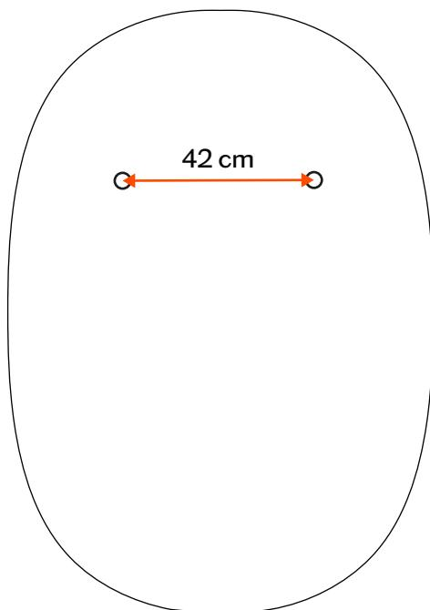
Inserire i fischer in dotazione nei fori precedentemente eseguiti nel muro (a 42 cm di distanza). | Insert the fischer plugs into the holes previously done on the wall (at a distance of 42 cm).
